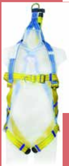
Figura 88. Arnés con cinta de extensión dorsal provisto de una anilla "D" para conectar a los equipos de rescate facilitando y minimizando así cualquier molestia al trabajador durante dicho proceso. Fuente: http://www.irudek.com/
